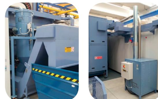
Sistema centralizado de aspiración de viruta y líquido sobre algunas áreas de trabajo con descarga automática sobre cinta transportadora.
