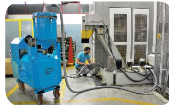
Aspiración de líquidos y incorporación simultánea de los mismos filtrados en un depósito de una máquina de herramienta para fresado y taladrado
