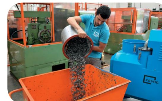
Vaciado del cesto de viruta después de la limpieza de una máquina de tallado de engranajes cónicos
