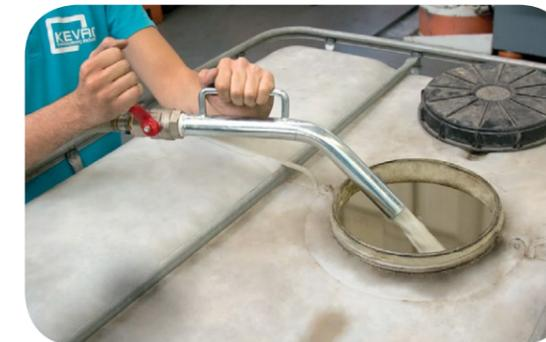
Expulsión del líquido filtrado en un contenedor para la eliminación del material recogido
