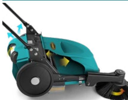
La rueda lateral de la barredora, además de activar el cepillo principal, también activa un eje de transmisión conectado a un ventilador. La relación entre la rueda y el eje de transmisión crea una fuerte succión, que recoge el polvo y lo canaliza hacia el filtro.
